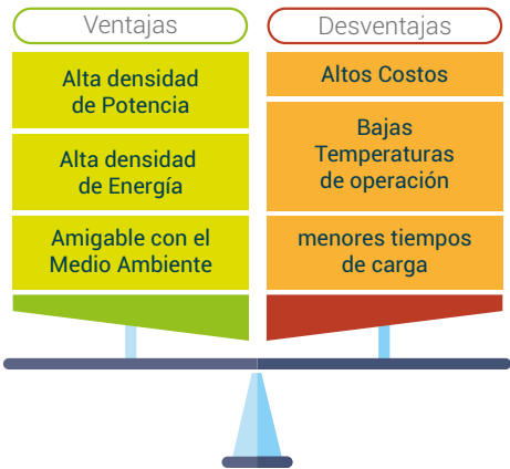
Ilustración 6. Ventajas y desventajas del almacenamiento con bobinas superconductoras
